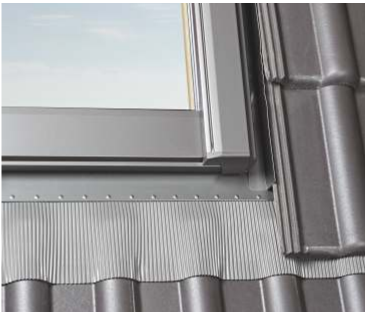
Оклад EDW — профиль кровли до 8,0 см
